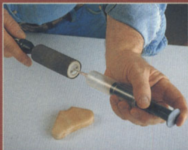
Sopra: per la carteggiatura definitiva, ammorbidite il rullo, sgonfiandolo, per operare delicatamente su tutta la superficie del pezzo.
