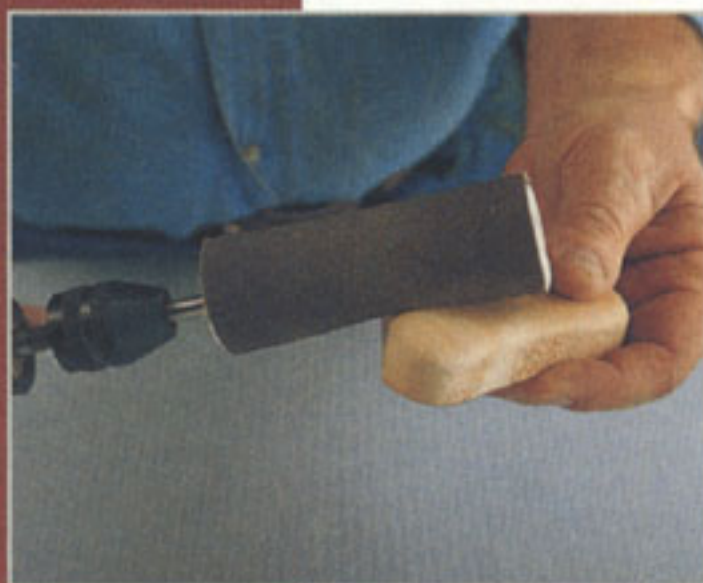
In alto, a sinistra: carteggiate per eliminare gli spigoli vivi. In mezzo: controllate frequentemente per aggiustare la forma. A destra: esempio di come arrotondare i pezzi, per realizzare una graduale passaggio da un livello al successivo
