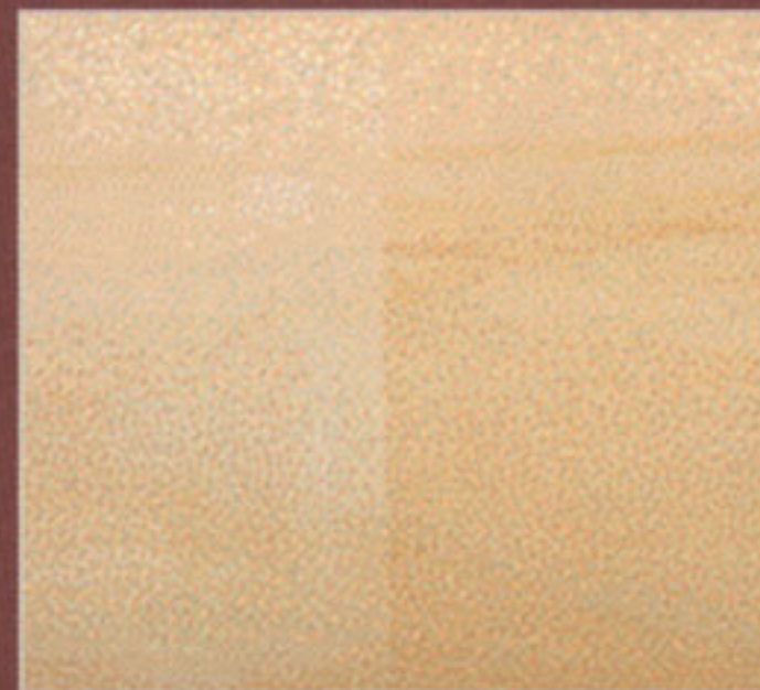
Comparazione dei toni di giallo di due prodotti di finitura su un legno bianco.
