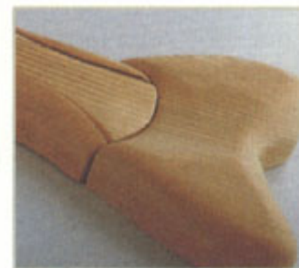
In alto, a sinistra: carteggiate per eliminare gli spigoli vivi. In mezzo: controllate frequentemente per aggiustare la forma. A destra: esempio di come arrotondare i pezzi, per realizzare una graduale passaggio da un livello al successivo
