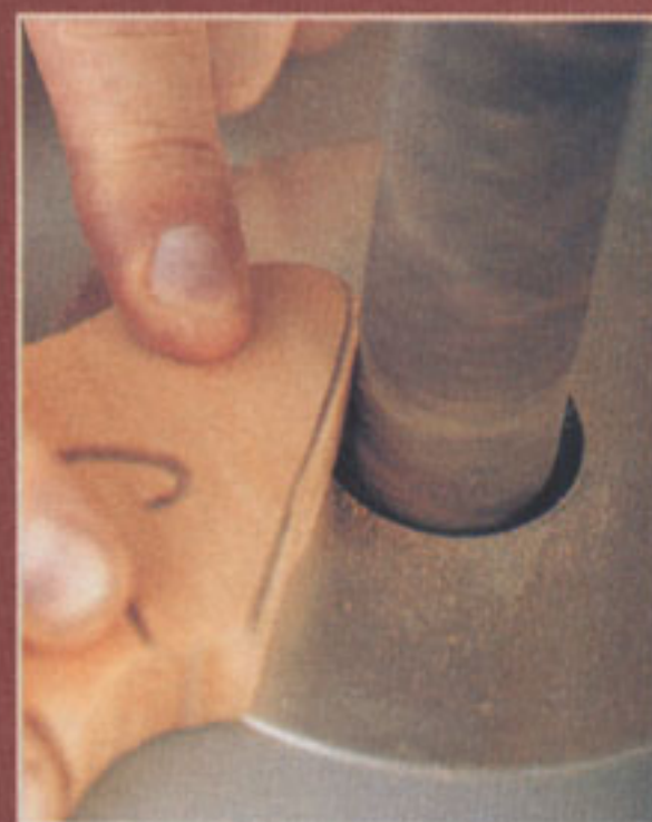
Sopra: tracciate nuovamente sulla base del pezzo, dove questo è risultato più largo, e carteggiate fino alla linea; a destra: un rullo per carteggiare verticale, un rullo montato su un trapano elettrico portatile sono usati per squadrare i bordi.
