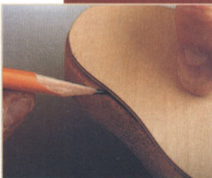
Sopra: tracciate nuovamente sulla base del pezzo, dove questo è risultato più largo, e carteggiate fino alla linea; a destra: un rullo per carteggiare verticale, un rullo montato su un trapano elettrico portatile sono usati per squadrare i bordi.
