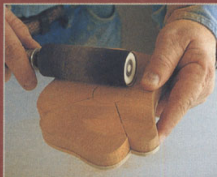
Sopra: per la carteggiatura definitiva, ammorbidite il rullo, sgonfiandolo, per operare delicatamente su tutta la superficie del pezzo.
