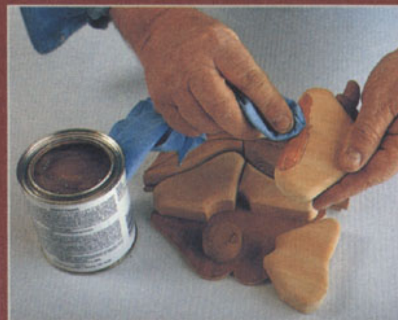
Applicazione di pasta/gel sui singoli pezzi.
