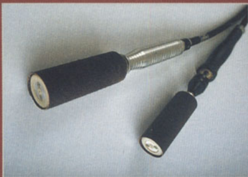
Questo tipo di rulli pneumatici rappresenta la serie di utensili più importanti da me usati per carteggiare e per modellare.
