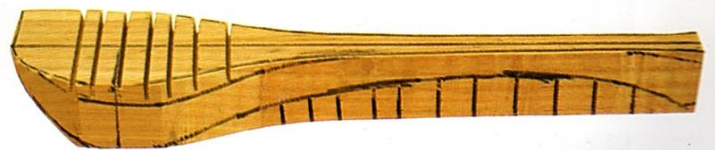
Harmadik fázis A felesleg eltávolításának alternatív módja: fűrészszel készített bemetszések
